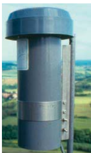
Balise IRSN de télésurveillance des débits de dose du rayonnement gamma ambiant.
