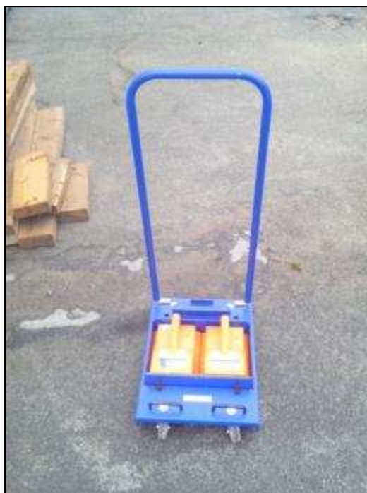
Figure 4 : Ensemble LB124-300 avec chariot (surface de détection 600 cm 2 )
