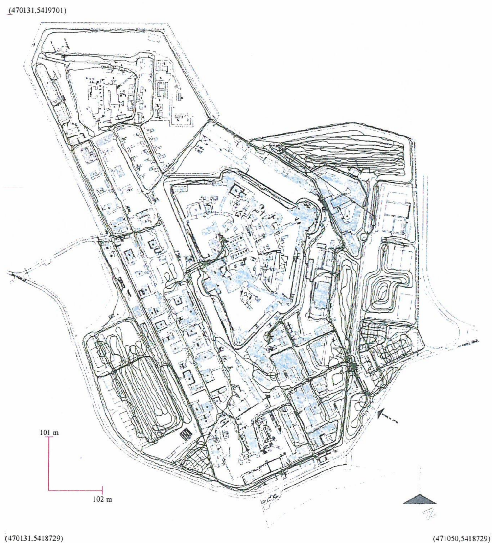
Figure 1 : Trajectoires effectuées sur le site de Vaujours par le véhicule de mesure gamma AUTONUC.
