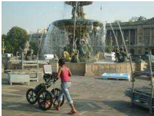
Mono-antennes de 400 Mhz sur chantier PYROTECHNIS (place de la Concorde)
