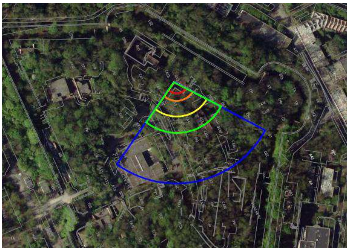
Zone d'effet lors de la préparation à la destruction dans le bâtiment RX2
