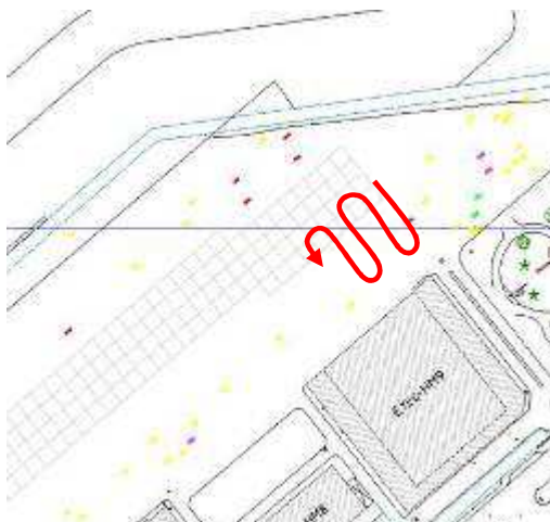
Sens de déconstruction d'un dallage avec la pelle située sur celui-ci
